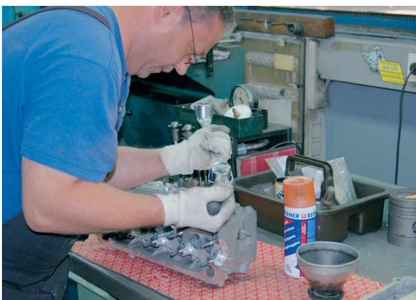
Von Hand: Das kennt auch jeder Werkstattfachmann – das Ausdrehen von Stehbolzen und Nacharbeiten von Gewinden ist mühevoll und zeitaufwändige Kleinarbeit. Bild: Schmidt
