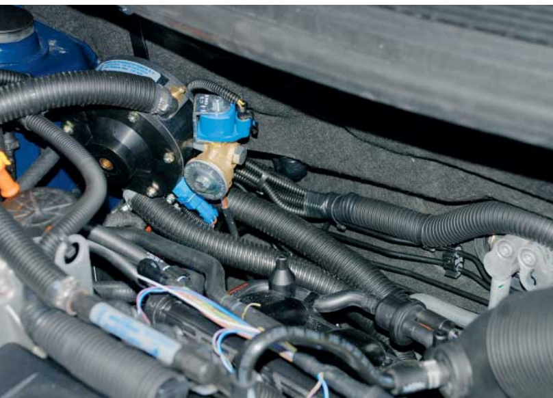
Ordnungsgemäß: Leitungen und Kabel der Gasanlage müssen sauber verlegt und befestigt sein, wie es im Bild bei dem vom Autohaus Maimann umgerüsteten Fahrzeug zu sehen ist. Bild: Schmidt
