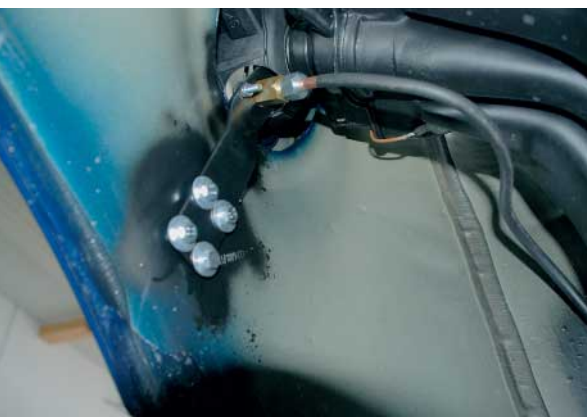
Qualitätsarbeit: Die Halter für die verschiedenen Komponenten der Gasanlage, im Bild für den Tankstützen, müssen aus stabilem Material angefertigt und zureichend befestigt sein.
