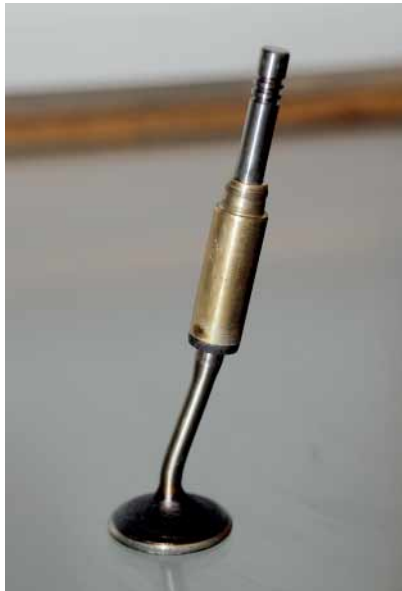
Rissopfer: Ein typisches Schadensbild für einen gerissenen Zahnriemen ist dieses verbogene Ventil. Der Rumpfmotor trug dabei keinerlei Schaden davon, weshalb die Instandsetzungskosten dank Zylinderkopf-reparatur moderat blieben.
