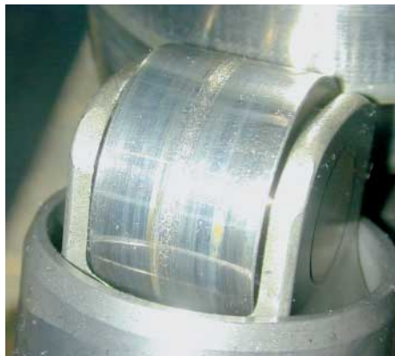
Angefressen: Ist das Öl verschlissen, hinterlässt dies selbst bei Rollenstößeln Fressspuren.
