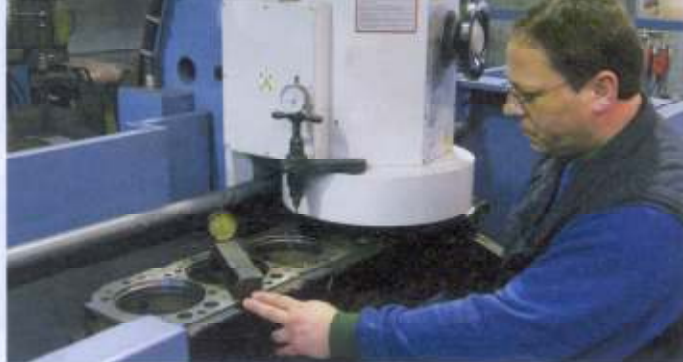
Für den perfekten Sitz – planen eines Motorblocks.
