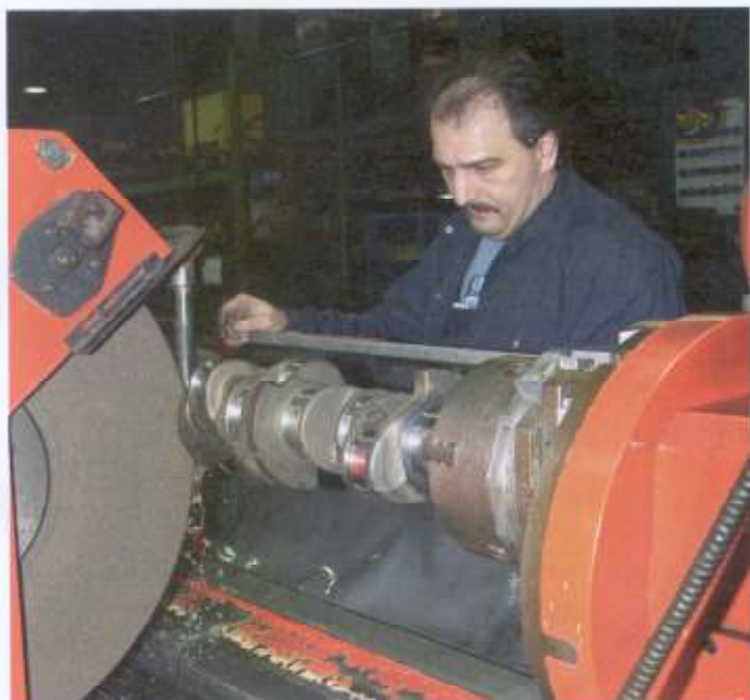
Arbeiten mit höchster Präzision – schleifen der Lagerflächen einer Kurbelwelle.
